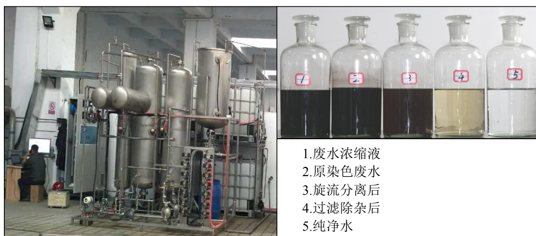
图 3.7 染色残液三相旋流连续脱色与再生盐水循环利用设备及效果
