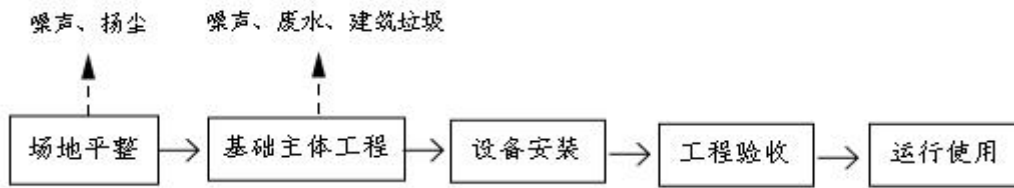
图 3.5-1 施工工艺流程及产污节点图
