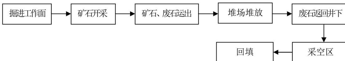
因矿体特征限制,开发利用方案选择自上而下逐中段开采、浅孔留矿法回采,开采中产生的废石即时回填采空区可能性小,开采废石须运出地表堆放。矿山闭坑后,堆场内废石返回井下回填采空区,回填顺序为自下而上、由里到外。
