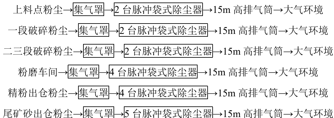
图 3.4-3 有组织粉尘收排系统示意图
