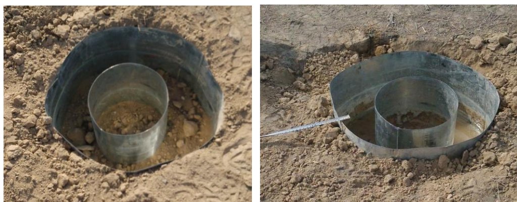
图 5-3 渗水试验工作照片
